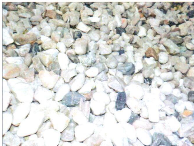
foto /5/ Detailní pohled na násyp kameniva – směs praného říčního kameniva (kačírku) a drceného kameniva
